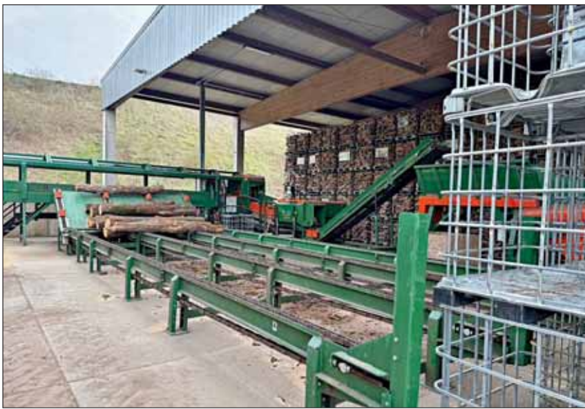
Kern der Brennholzproduktion ist eine Säge-Spalt-Anlage von Posch.
