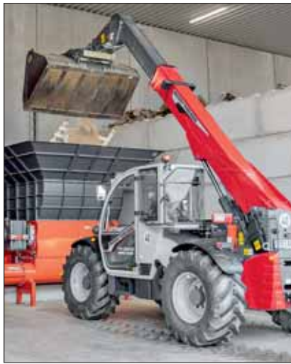
Die Beschickung erfolgt mit einem Teleskoplader.
