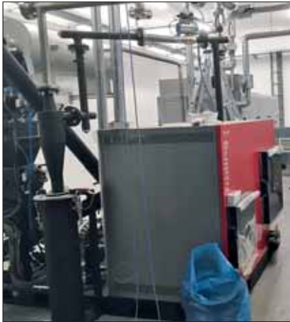
Die Trockenkammern werden mit Wärme aus der Hackschnitzel-Heizung betrieben, außerdem erzeugt man mit einer Vergaseranlage von Fröling Strom.
